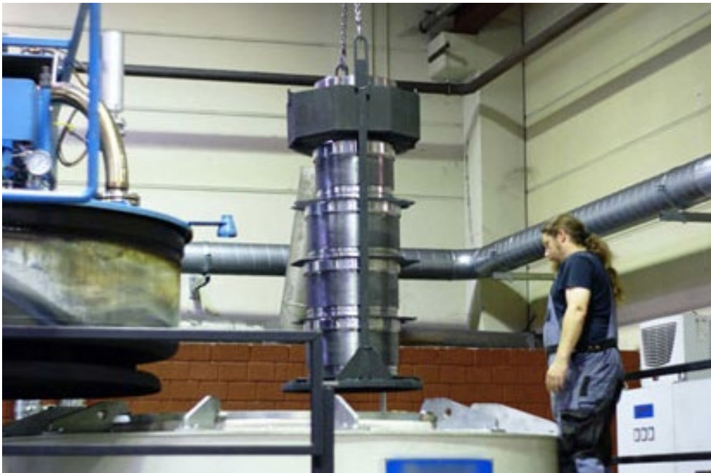
Prozessablauf für Gasnitrocarburieren +oxidieren, ca. 15h
